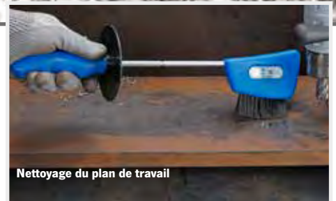
Élimination des copeaux de fraisage à arêtes tranchantes
