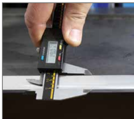
Largeur de chanfrein max. 30 mm
