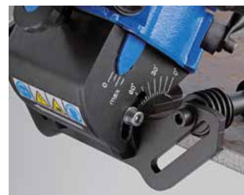
Réglage de l'angle en continu de 15° à 60°
