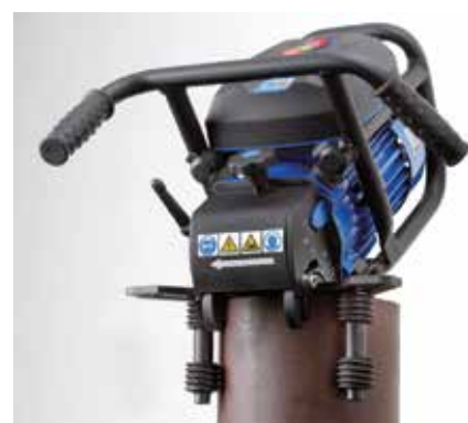
Traitement des arêtes de tubes en position verticale
